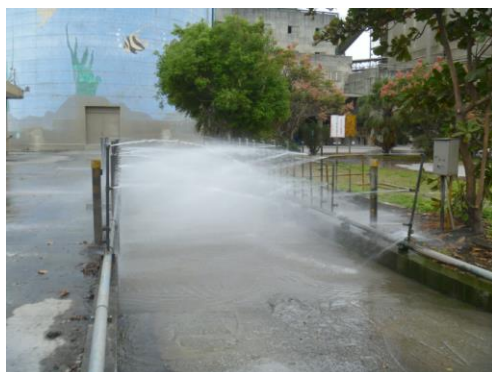
自動洗車設備
